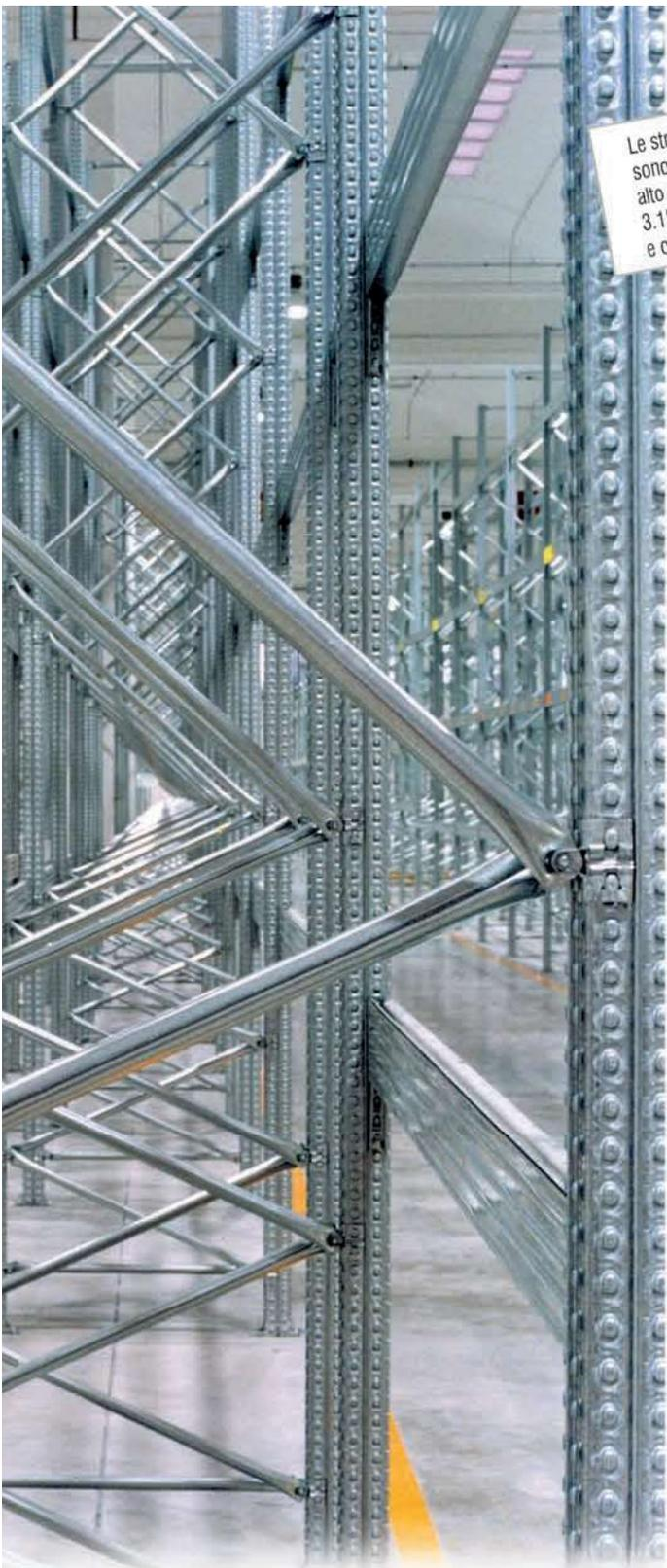
Le strutture SUPER 4-5-6 sono prodotte con acciaio alto resistenziale certificato 3.1B secondo le EN10204, e omologate TÜV/GS.
