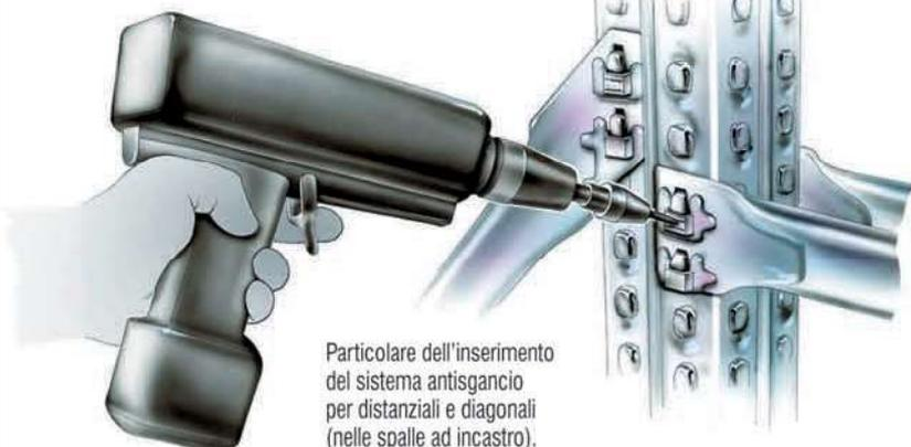
Particolare dell'inserimento del sistema antiscaccio per distanziali e diagonali (nelle spalle ad incastro).
